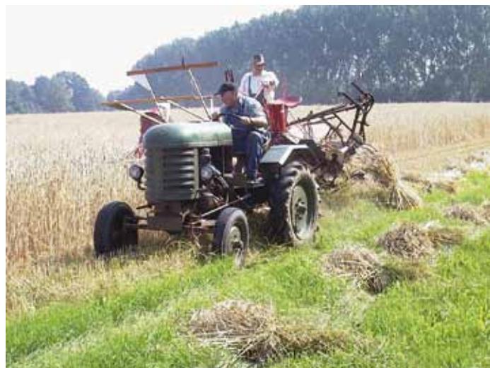
Jetzt zwar schon ohne Pferdekraft, doch mit Pferdestärken: Ernte mit dem Trecker Ohrenstein und Koppel, 18 PS, Baujahr 1952, mit Mähbinder, in den 50er Jahren.
